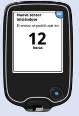
Sostenga el lector a menos de 1.5 pulgadas (4 cm) del sensor para escanearlo. El sensor se podrá usar para revisar su glucosa después de 12 horas.
