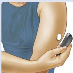
Sostenga el lector a menos de 1.5 pulgadas (4 cm) del sensor para escanearlo.
