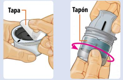
Desprenda por completo la tapa del envase del sensor. Desenrosque el tapón del aplicador del sensor.
