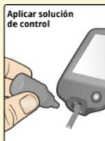
Agite el frasco de solución de control para mezclar la solución. Aplique una gota de solución de control en el área blanca del extremo de la tira de prueba.
