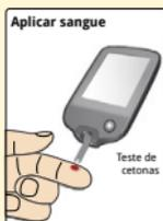
Utilize o dispositivo de punção para obter uma gota de sangue e aplique o sangue na área branca na extremidade da tira de teste.
