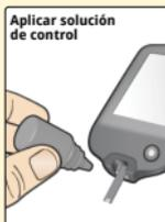
Agite el frasco de solución de control para mezclar la solución. Aplique una gota de la solución de control a la zona blanca en la punta de la tira reactiva.
