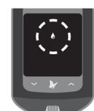
La parpadea para indicar que el medidor está listo para que aplique una muestra a la tira de prueba.
