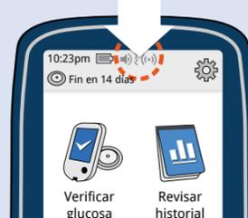
Cuando alguna alarma está activada, el sonido/vibración y el estado de la señal se muestran en la pantalla inicial.
