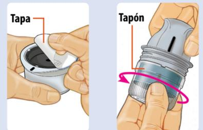
Desprenda por completo la tapa del envase del sensor. Desenrosque el tapón del aplicador del sensor.
