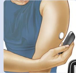
Sostenga el lector a menos de 1.5 pulgadas (4 cm) del sensor para escanearlo. El sensor se podrá usar para revisar su glucosa después de 12 horas.
