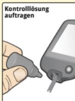
Schütteln Sie das Fläschchen mit der Kontrolllösung, um die Lösung zu vermischen. Tragen Sie einen Tropfen Kontrolllösung auf den weißen Bereich am Ende des Teststreifens auf.
